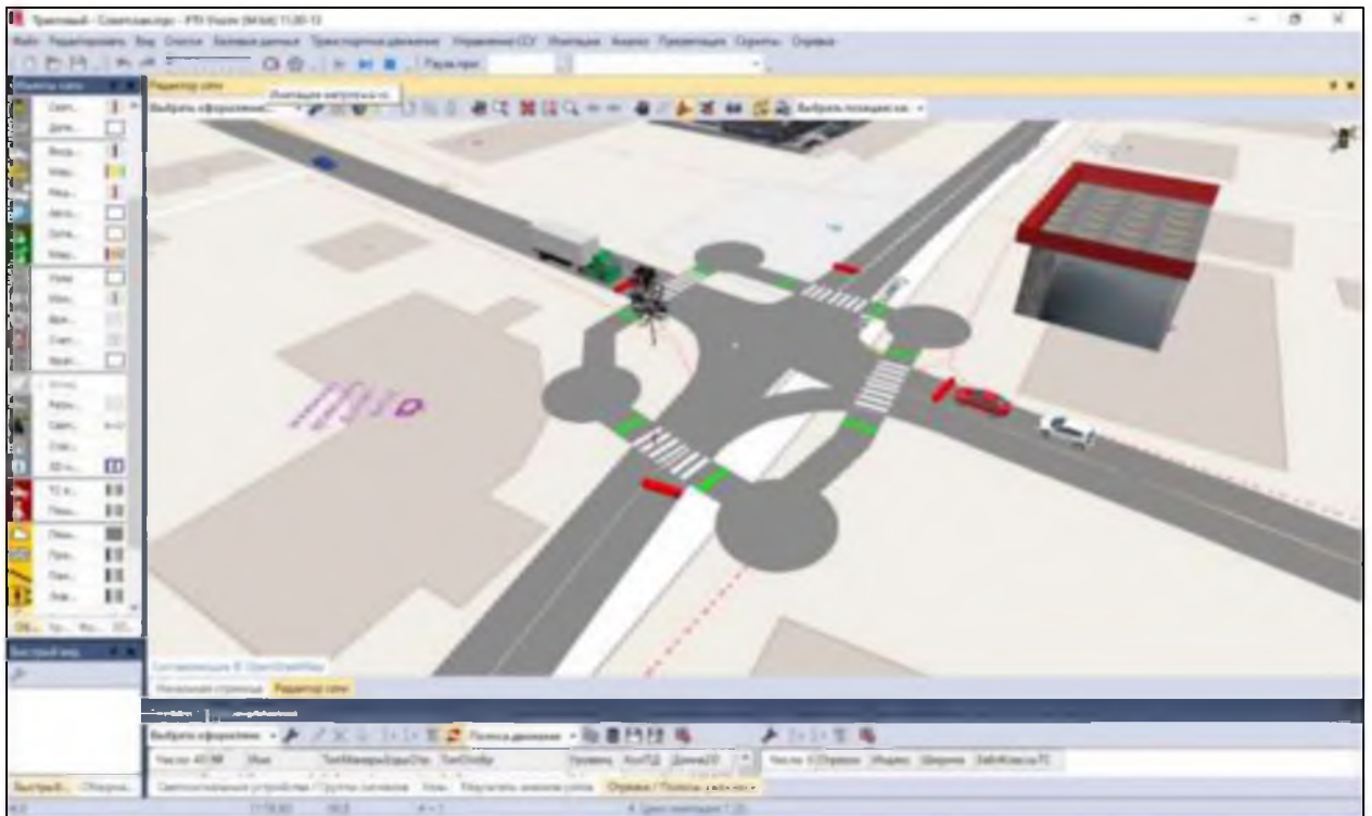
Рисунок 2.3.1 – 3D-модель функционирования регулируемого перекрестка ул. Тракторная – ул. Советская, с. Орда (снимок экрана в программе PTV-Vissim)
